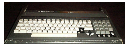
Das Gehäuse des V364 von Bo Zimmermann ist schon kaputt, aber er funktioniert noch. Es wurde schlechtes Plastik verwendet.
