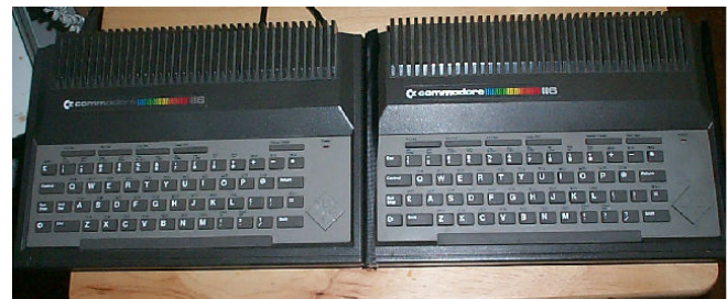
Vergleich C116 (man beachte die Tasten): Links: Ein seltener C116 NTSC Prototyp Rechts: Ein normaler C116 mit PAL-Chips
