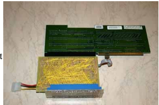
Und hier die Rückseite des Busboards
