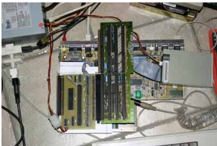
A500 mit eingebautem A4000-Busboard (von oben fotografiert)
